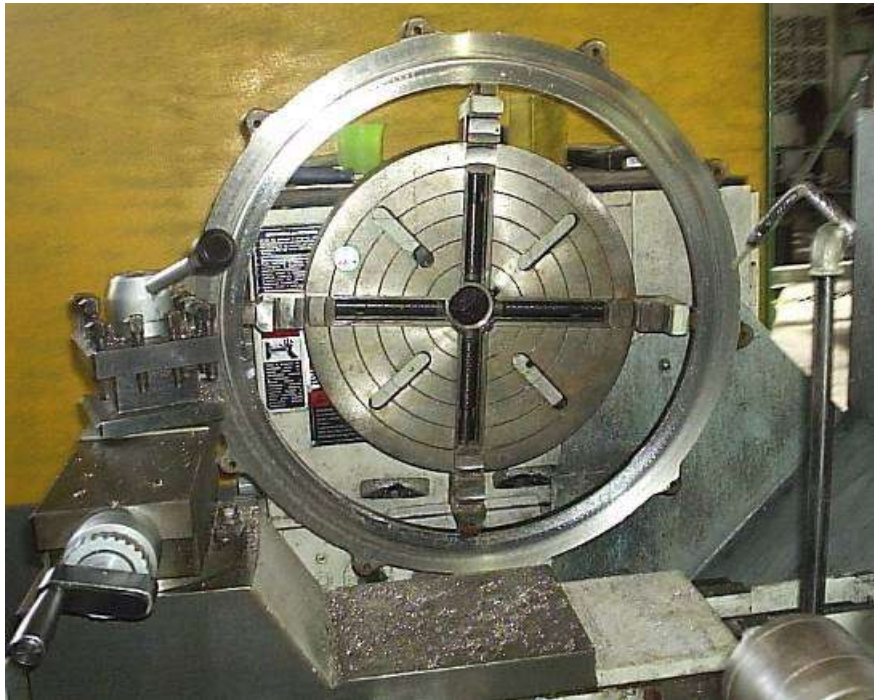
Usinagem de Flanges
