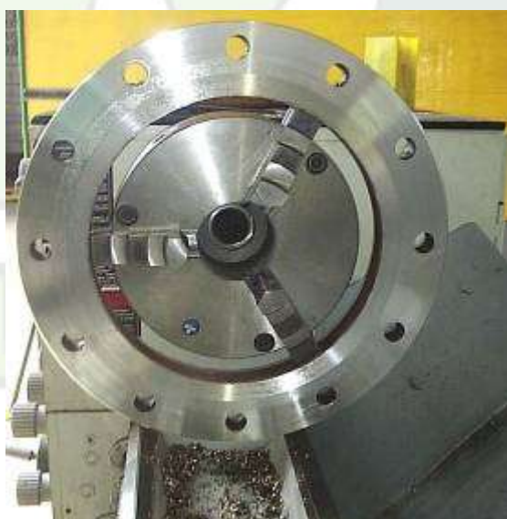
Usinagem de Flanges
