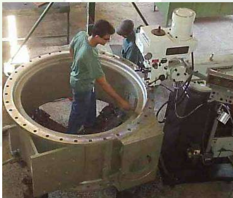
Usinagem de Válvula do Alto Forno da ArcelorMittal – Diâmetro de 1500mm
