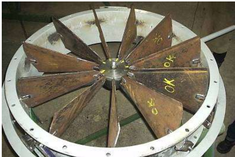
Fabricação de Damper do Alto Forno da ArcelorMittal
